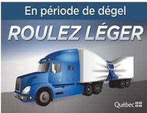
En période de dégel, la route est de 30 à 70 % plus fragile qu'en temps normal. Un seul véhicule en surcharge peut lui causer des dommages importants. Par contre, une faible diminution des charges réduit considérablement les dommages causés à la chaussée. C'est pour cette raison que des restrictions de charges sont imposées aux véhicules lourds en période de dégel.
